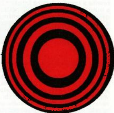
Obr. 3. Schéma záření FZP antény s označením hlavních rozměrů. Z propustných (červenných) kruhových zón FZP antény se v ohnisku F_0 sečtou jen vlnové paprsky se stejnou fází
