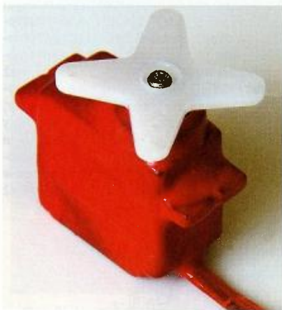
Obr. 32. Servo obalené tekutou gumou Plasti Dip
