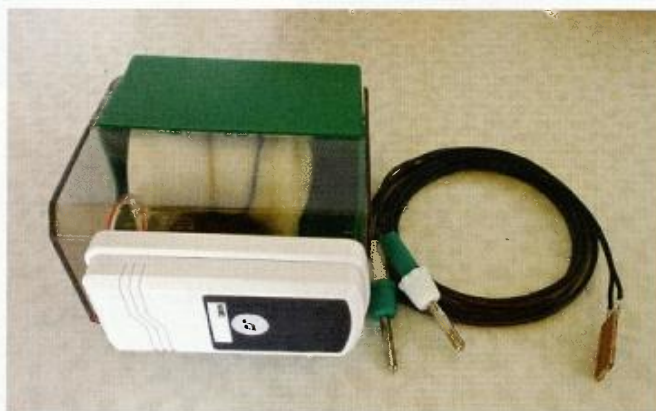
Obr. 3 a 4. Připojení tlačítka a desky snímací a spínací části přípravku
