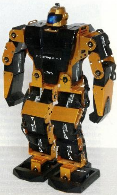
Obr. 25. Robot Robonova-1 není nic jiného, než 16 pospojovaných robotických serv, akumulátor a řídicí jednotka
