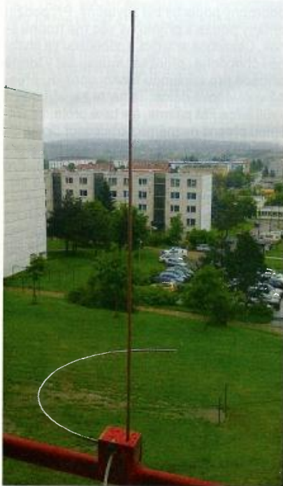
Obr. 2. Upravená verze „všesměrového kruhového“ půlvlnného dipólu. Je nejjednodušší FM anténou na balkóny i okenní rámy, kompromisem mezi kusem drátu a „velkými“ anténami. Délka prutu i obvod půlkruhu jsou \lambda/4 , čili asi 75 cm. Na balkoně či lodžii ji lze snadno umístit do prostoru nejlepšího příjmu žádané stanice a s kvalitním tunerem mimo střechy nejvyšších budov. Chceme-li oddělit dvě stanice s různou polarizací, vysílající na stejném kmitočtu (k čemuž potřebujeme tuner s velmi nízkým výběrovým poměrem), použijeme raději celý přímý dipól s příslušnou H nebo V orientací. I takovéto „hračky“ dávají překvapivě dobré výsledky, celovlnnému čtverci se ale nevyrovnají
