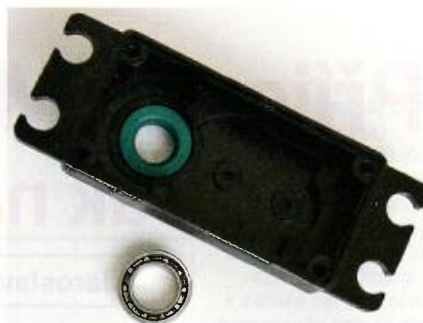
Obr. 33. Náhrada horního ložiska v krytu guferem
