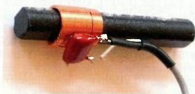
Obr. 94. Feritová anténa 10 x 50 mm, kondenzátor nastavuje rezonanční kmitočet (v tomto případě 77,5 kHz pro příjem časového signálu DCF)
