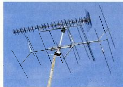
Obr. 6. Čtrnáctiprvková anténa „Jäger Welle“ (dole, horní anténa je pro vyšší pásmo), nejlepší FM anténa pro dálkový příjem v otevřeném terénu bez odrazů a stojatého vlnění. Tato fotografie je převzata z webových stránek Jihlavského DX a Hi-Fi klubu ( www.dxradio.cz ), kde také případní zájemci najdou podrobný návod ke konstrukci. Hotová se v naší distribuční síti koupit nedá a podle zpráv DX fandů to už nejde ani v Německu
