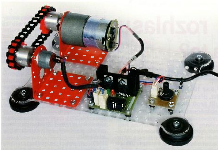
Obr. 31. Servo s větším motorem a převodovkou, servozesilovač konstrukční
