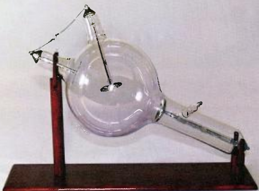
↑ Rentgenka – elektronka, jejíž anoda je zdrojem rentgenového záření
