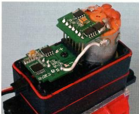
Obr. 24. Těsnění gumou mezi díly krytu maxiserva
